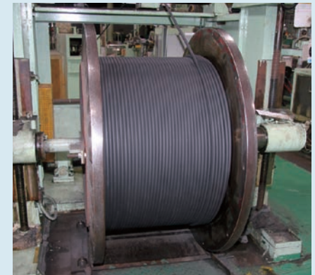
▲ ドラムに巻かれた絶縁体
