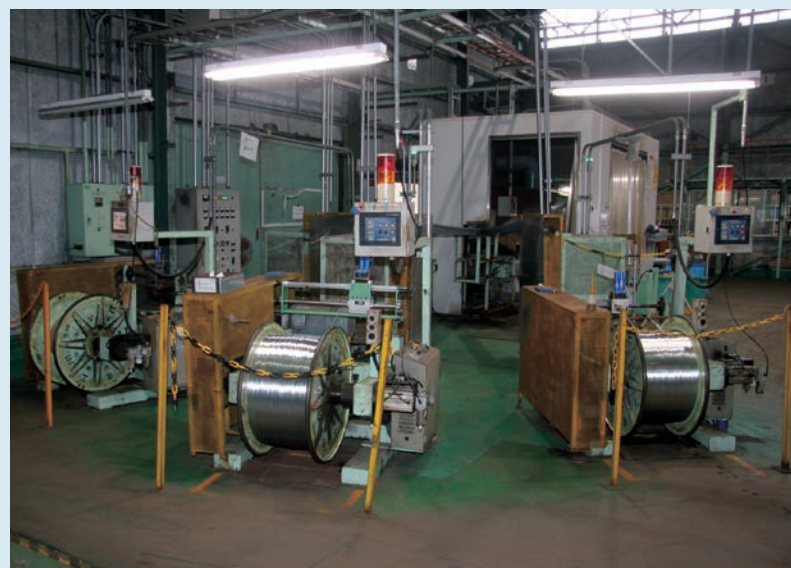
▲ スズ引きライン(軟銅線にスズ引き処理)
