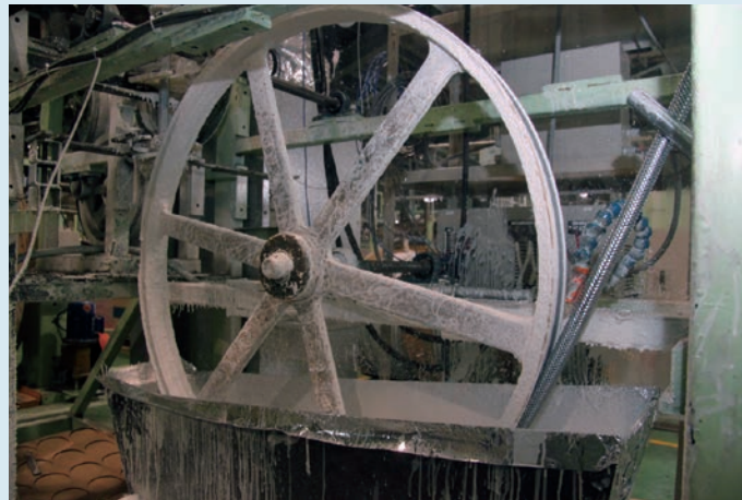
▲ あじろ鍍装された後、水性塗料により塗装される
